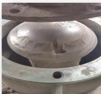
Van hình cầu bị mòn
